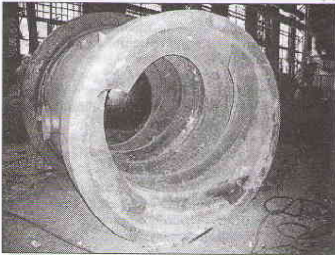
Фото 3. Отливка «Патрубок» ч. 1-297971, масса отливки 19500 кг, 25Л, толщина стенки отливки 125 мм.
