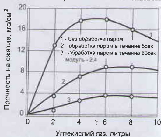
Рис. 4: Зависимость прочности безглинистой смеси от расхода CO_2 и последующей обработки её паром
