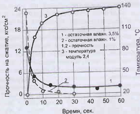
Рис. 3: Зависимость прочности смеси в продутым CO 2 состоянии и температуры образца от продолжительности обработки паром
