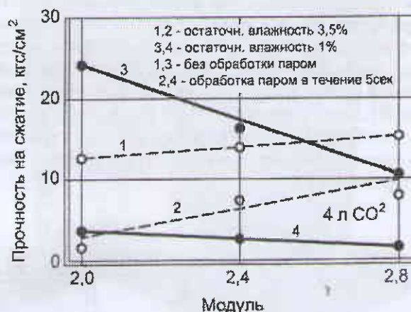
Рис. 6: Зависимость прочности безглинистой смеси в исходном состоянии и после пропаривания от модуля жидкого стекла и остаточной влажности
