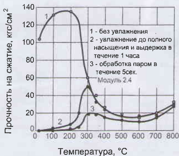
Рис. 2: Изменение прочности ЖС в зависимости от температуры их прокаливания и интенсивности последующей гидротации
